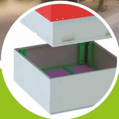
Der Behälter ist so konstruiert, dass er nicht Umkippen kann. Es handelt sich um eine spezielle Wanne, deren Boden mit Beton belastet ist, ausgestattet mit Sorptionsmatten zur Verhinderung des Austretens gefährlicher Stoffe.
